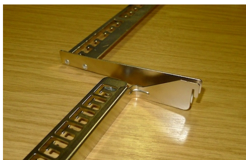
Diseño del nuevo organizador de cables, más corto, junto al diseño actual
